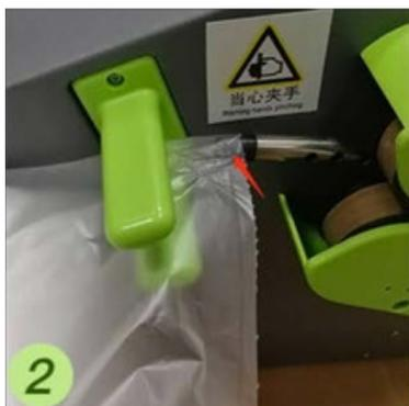
Utilice las guías para el film e introduzcalo por la pipeta de aire.
