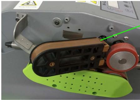
Jale del bloque para cambiar la cinta, Retire la cinta original por sección y vaya pegando la cinta nueva
